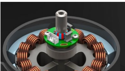
Zweikanaliger Hall-Effekt Encoder zur Erfassung der Drehung einer Motorwelle
