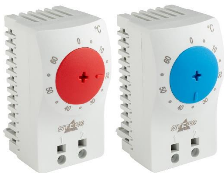
Klein-Thermostate von STEGO - links im Bild: KTO 111 Öffner (NC) zur Regelung von Heizgeräten - mit rotem Temperatur-Einstellrad; rechts im Bild: KTS 111 Schließer (NO) zur Regelung von Kühlgeräten - mit blauem Temperatur-Einstellrad.
